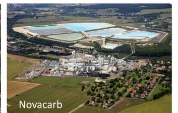
Lorsque la saumure est trop appauvrie, elle est dirigée vers de grands bassins de décantation, dans lesquels se déposent du gypse et du calcaire imprégné d'eau salée. L'eau surnageante est ensuite rejetée vers la Meurthe.
